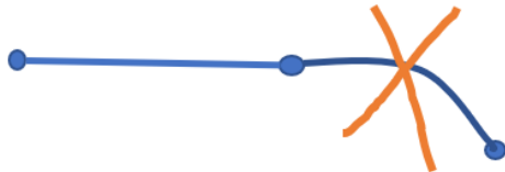
Figur 4. Linje med en cirkelbåge. Cirkelbåge är olämpligt att använda vid datautbyte.
