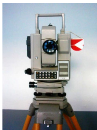
Figur 8. Principen vid korresponderande trigonometrisk höjdmätning (till vänster). Mätningen utförs samtidigt – kikare mot kikare eller mot en särskild måltavla placerad i förlängningen av totalstationens horisontalaxel (till höger).
