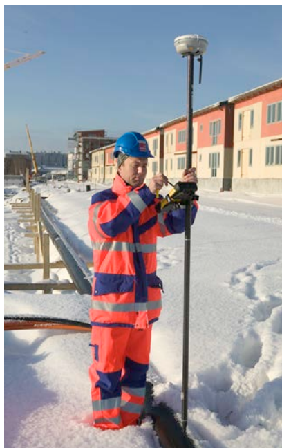
Figur 2.1.1. Utrustning vid mätning med nätverks-RTK. Antenn/mottagare i toppen och en fältdator mitt på mätstången. Foto: Lantmäteriet.
