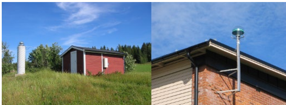
Figur 27. Exempel på fasta referensstationer i Swepos-nätet, klass A (vänster) respektive klass B (höger).
