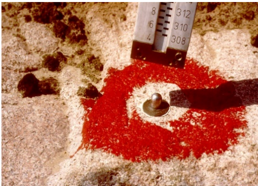
Figur 22. En typisk höjdfix i RH 2000-nätet.
