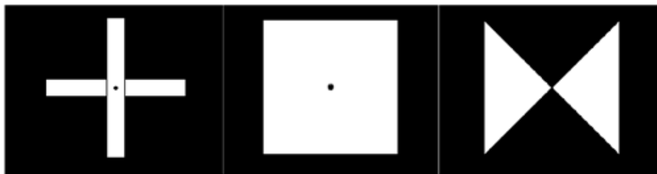
Figur 3.1.2b. Exempel på vanliga signalformer för HMK-standardnivå 1, 2 och 3: kors, kvadrat och diamant (Källa: Lantmäteriet).
